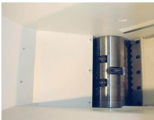
Der Zerkleinerungsrotor wird aus einem einzigen Stahlblock gefertigt, worauf dann die Widia Wendepplatten-Vierkantmesser montiert werden. Die Messer sind schnell austauschbar und werden mit Schrauben auf dem Rotor fixiert.
